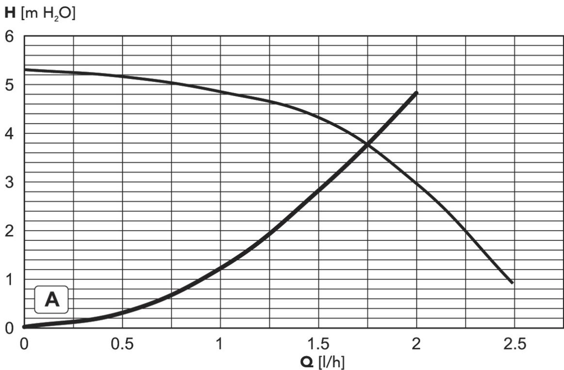
**A:** Perdite di carico caldaia
